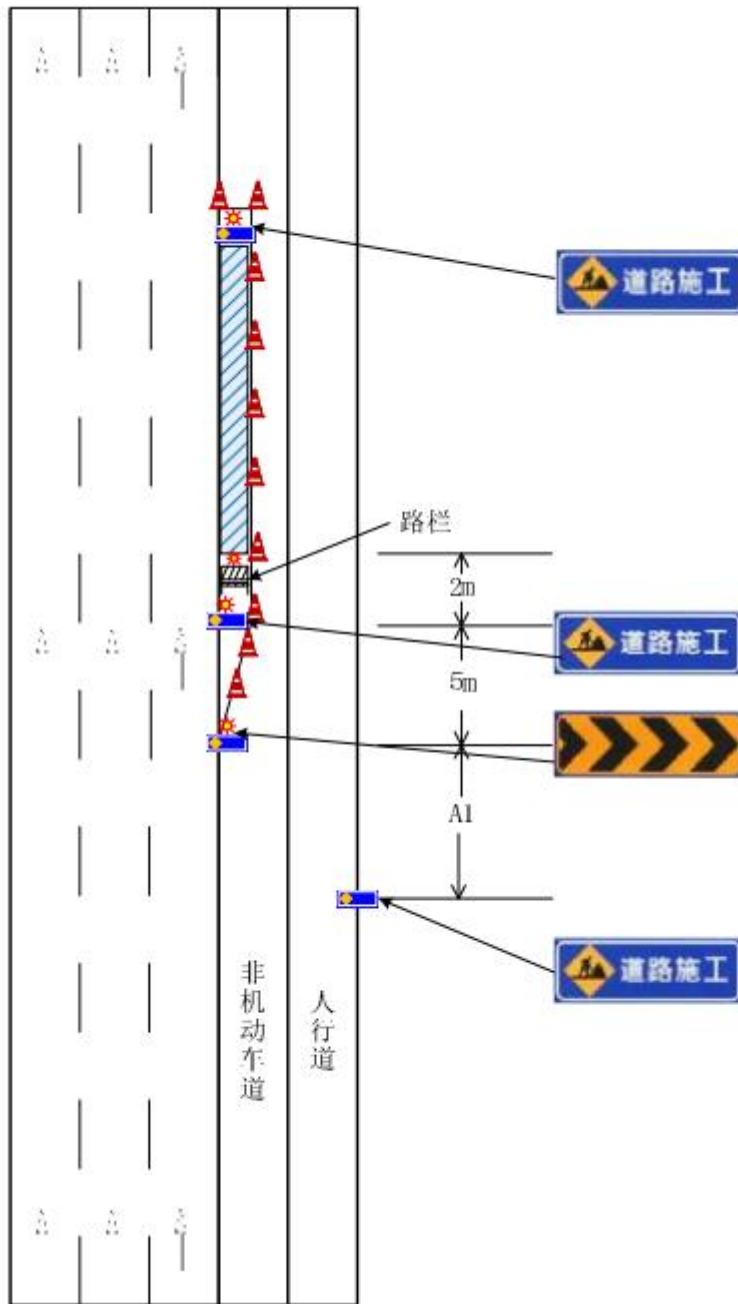
图 A.9 占有非机动车道的占道作业
